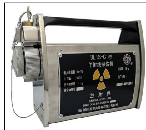
图 9-3 典型 ^{75}\text{Se} - \gamma 射线探伤机外观图
